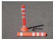
3~5年経過して汚れた状態
